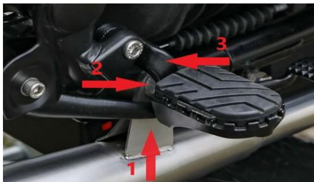
1 – Auspuffhaltelasche, 2 – Aludistanzhülse, 3 – Fußrastenträger (Gezeigte Ausführung für Rechts, Links ist entsprechend zu montieren)
